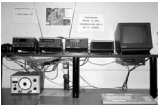
Foto oben: GW/KW Radio mit 2 DSC-Controller+LS; unten: Rufgenerator, VHF Handy, Telex Terminal.
